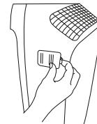
5. Vuelva a colocar la cubierta de la carcasa como se muestra en la imagen, hasta que note y oiga que encaja (cierre magnético). Enganche el cierre magnético primero abajo y, a continuación, arriba.
