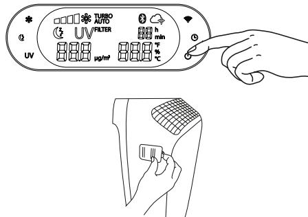
5. Ponownie nałożyć pokrywę obudowy, jak przedstawiono na rysunku, aż zablokuje się w sposób słyszalny i widoczny (zamknięcie magnetyczne). Zawiesić zamknięcie magnetyczne najpierw na górze, a następnie na dole.
