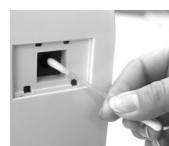
Затем промокните очищенные детали сухой ватной палочкой.
