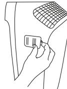
5. Закройте крышку корпуса до появления ощущения щелчка (магнитный замок). Потяните магнитный замок сперва вниз, а затем вверх.
