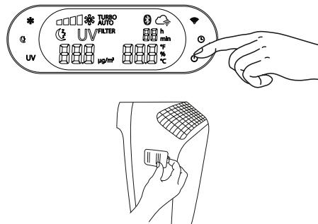
6. Inserire la spina nella presa. Posare il cavo di alimentazione in modo che nessuno possa inciampare. Premere il pulsante ON/OFF. Quindi aprire lo sportello laterale sul corpo dell'apparecchio. Qui è presente un pulsante per azzerare il contatore delle ore di esercizio.
