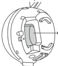
4. Sen jälkeen voit asettaa kotelon kuoren takaisin laitteeseen ja asettaa akkukotelon kannen paikalleen.
