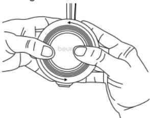
2. Løsn derefter kabinetdelen på siden af batteridækslet.
