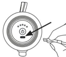
3. Conecte el cable USB-C a un conector de red (no incluido en los artículos suministrados). Enchufe el conector de red a una toma de corriente adecuada. El indicador del nivel de carga de la batería **1** muestra el nivel de carga actual.
