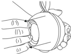
3. Estrarre la batteria ricaricabile dal dispositivo e scollarla da quest'ultimo tramite il connettore.
