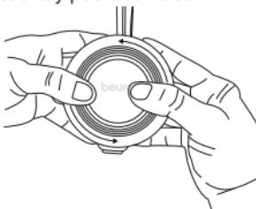
2. A continuación, suelte la carcasa del lado de la cubierta de la batería.
