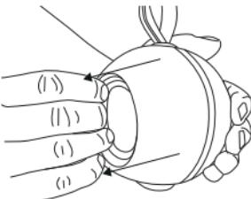
3. После этого извлеките аккумулятор из прибора и отсоедините его от прибора через штекерный разъем.
