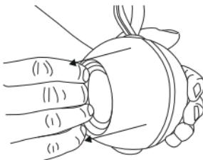
3. Træk nu batteriet ud af apparatet, og adskil batteriet fra apparatet ved hjælp af stikforbindelsen.
