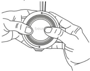
2. Desserrez ensuite le boîtier sur le côté du couvercle de la batterie.
