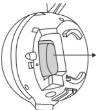
4. Successivamente è possibile riposizionare il guscio del corpo sul dispositivo e rimettere il coperchio della batteria.
