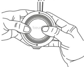
2. Затем отсоедините часть корпуса со стороны крышки аккумуляторного отсека.
