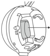
4. A continuación, puede volver a colocar la carcasa en el aparato y colocar la cubierta de la batería.
