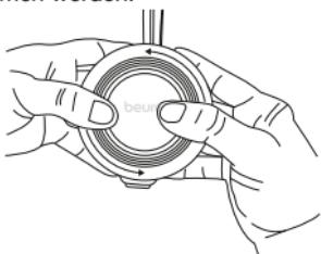
2. Lösen Sie anschließend die Gehäuseschale auf der Seite der Akkuabdeckung.
