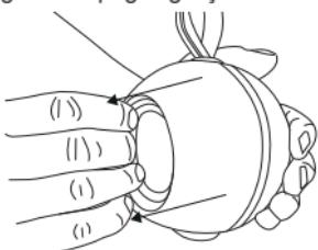
3. Şimdi pil cihazdan çekip çıkarın ve pilin soket bağlantısı üzerinden cihazdan ayıran.
