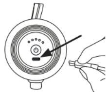
3. Collegare il cavo USB C a un connettore (non compreso nella fornitura). Inserire il connettore in una presa di corrente adeguata. L'indicatore di carica della batteria [1] indica lo stato attuale della batteria.
