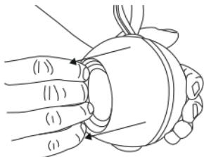
3. Extraiga ahora la batería del aparato y desconéctela del aparato a través del conector enchufable.
