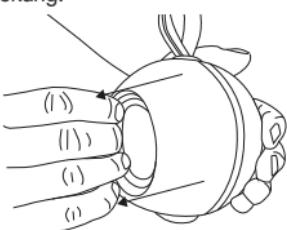
3. Ziehen Sie nun den Akku aus dem Gerät und trennen den Akku durch die Steckverbindung vom Gerät.
