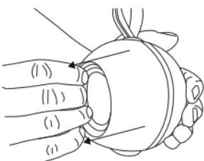
3. Trekk nå batteriet ut av apparatet, og koble batteriet fra apparatet ved hjelp av pluggen.
